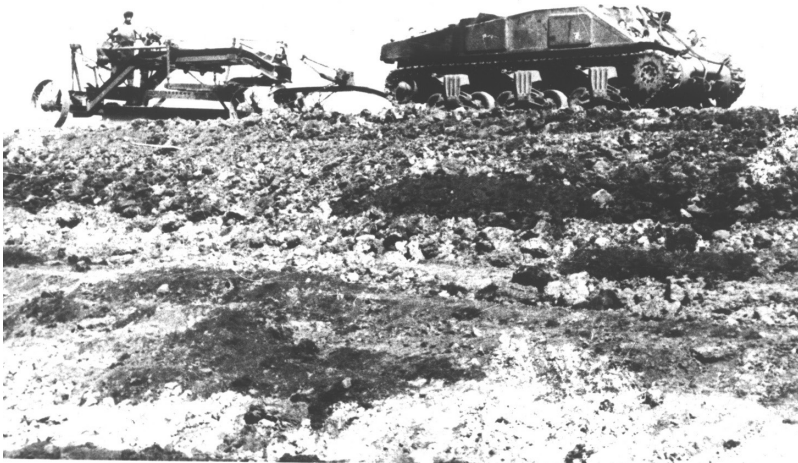
Рис. 1. Танк «Шерман» с демонтированной башней используется для вспашки. Магнитогорск, 1940-е гг.
